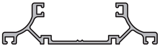
TAPA COLUMNA Y TERMINACION PARED Perfil: 4362 Peso: 0,505 Kg/m
